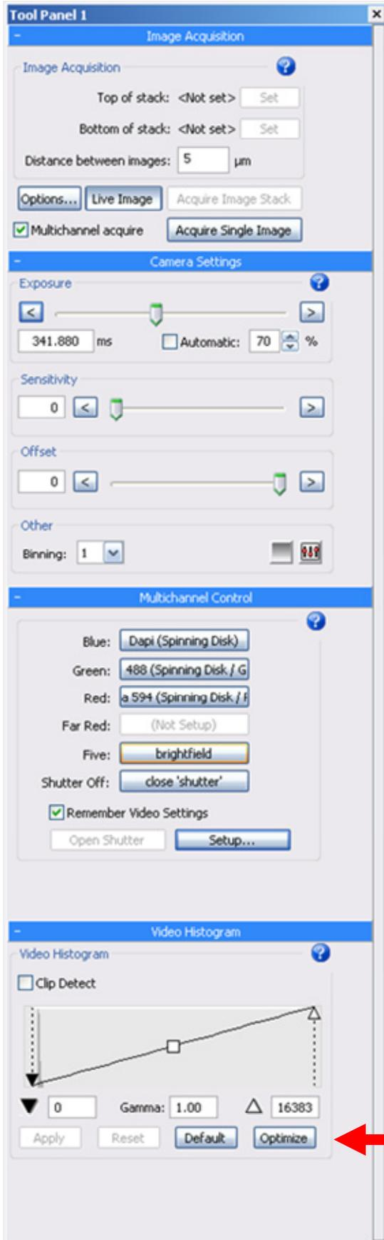
**Image Acquisition:** Contiene el comando “**Live Image**” que permite mostrar/ocultar en el área de visualización del **Monitor 1** las señales detectadas por la cámara. También este módulo es útil si se requiere capturar imagen de alguna región de interés; con la opción de realizar una captura a través del eje Z, con los fluorocromos activos listados en el módulo “**Multichannel Control**”.
